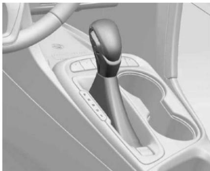
**P** : Esta posición bloquea las ruedas delanteras. Utilice P (estacionamiento) al arrancar el motor, ya que el vehículo no puede moverse con facilidad.
