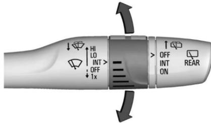
**INT** : Úselo para pasadas intermitentes o Rainsense, si está equipado y activado. Para ajustar la frecuencia de pasadas, gire la banda hacia arriba para limpiezas más frecuentes o hacia abajo para limpiezas
