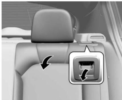
1. Jale la palanca en la parte superior del respaldo para desbloquear el respaldo.
