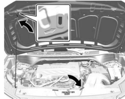
3. Levante el cofre y libere la varilla del cofre de su retenedor, encima del radiador. Coloque firmemente el soporte del cofre dentro de la ranura en la parte inferior del cofre.
