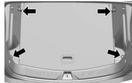
El vehículo puede estar equipado con cuatro amarres de carga en el compartimento trasero.
