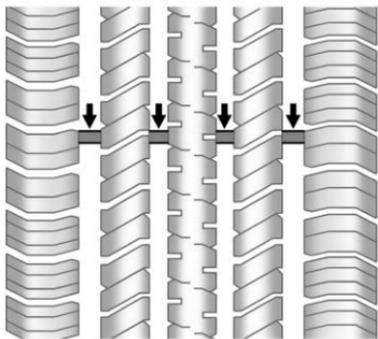
Los indicadores de desgaste del dibujo son una de las maneras de decidir cuándo es el momento para nuevas llantas. Los indicadores de desgaste aparecen cuando las llantas tienen solamente 1.6 mm (1/16 de pulgada) de dibujo remanente. Vea *Inspección de llantas* ⇨ 252 y *Rotación de la llanta* ⇨ 252.
