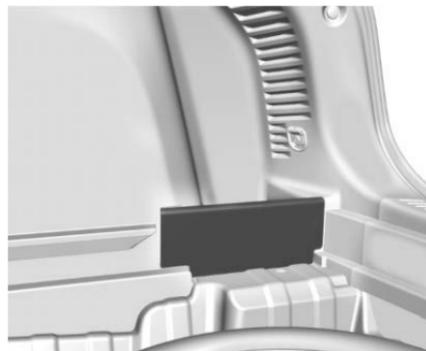
El tablero de almacenamiento inferior del cuarto trasero se puede retirar en el lado del pasajero. Levante el piso de carga para obtener acceso y jale el tablero para retirarlo.
