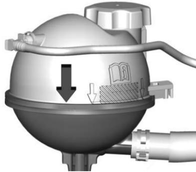
Revise si se alcanza a ver refrigerante en el tanque de compensación del refrigerante. Si el refrigerante que está dentro del tanque de compensación del refrigerante está hirviendo, no haga nada más hasta que se enfrie.
