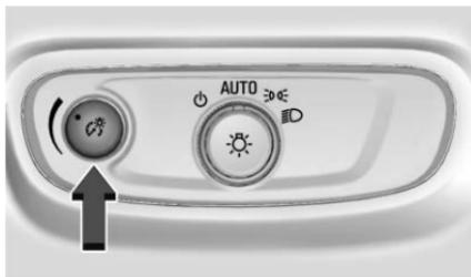
Esta función ajusta el brillo de todos los controles iluminados. El control de iluminación del tablero de instrumentos está junto al control de la luz exterior.
