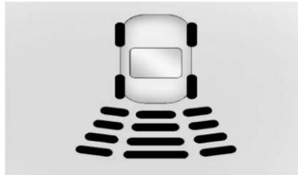
El grupo de instrumentos puede tener una pantalla de Asistencia de estacionamiento con barras que muestran la "distancia al objeto" e información de ubicación de objeto para el sistema de Asistencia para estacionamiento. Conforme el objeto se acerca, se iluminan más barras y las barras cambian de color de amarillo a ámbar a rojo.
