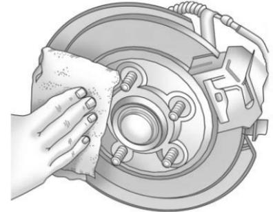
9. Elimine todo el óxido y la suciedad de los pernos de la rueda, las superficies de montaje y la rueda de refacción.
