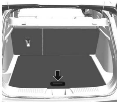
Levante el piso de carga para obtener acceso al sistema de administración de la carga.
