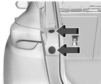
1. Retire y conserve ambos tornillos que sujetan el ensamble de la luz trasera a la carrocería del vehículo.
