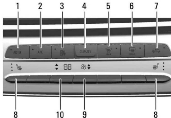
El calentamiento, enfriamiento y ventilación para el vehículo se pueden controlar con este sistema.
