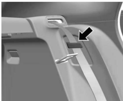
3. Coloque el cinturón de seguridad externo en el sujetador del cinturón de seguridad en la moldura lateral del vehículo.
