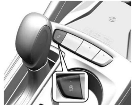
Si está equipado, la característica de paro/ arranque automático de motor se puede desactivar y activar presionando el interruptor con el símbolo
