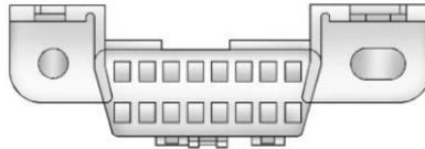
El DLC está debajo del tablero de instrumentos del lado izquierdo del volante. Conectar dispositivos que no se utilicen para realizar una Inspección de emisiones/Prueba de mantenimiento o para dar servicio al vehículo puede afectar la operación del vehículo. Vea *Equipo eléctrico incorporado* ⇨ 204. Visite a su distribuidor si necesita asistencia.
