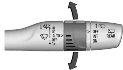
**AUTO (Automático)** : Mueva la palanca del limpiaparabrisas a AUTO: Gire la banda en la palanca del limpiaparabrisas para ajustar la sensibilidad.
