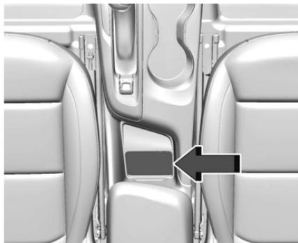
1. Coloque la llave remota en la cavidad de la llave remota, con los botones orientados hacia el frente del vehículo.
