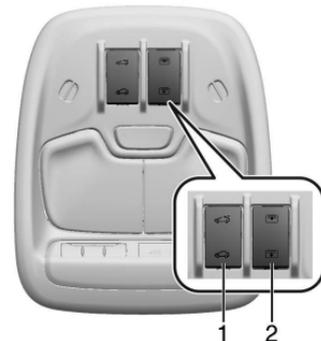
1. Interruptor de quemacocos (SLIDE/ VENT - Deslizar/Ventilar)
