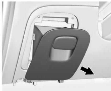
La caja de fusibles del tablero de instrumentos se encuentra en el lado inferior del tablero de instrumentos del lado del conductor. Para tener acceso a los fusibles, remueva el compartimento de almacenamiento. Para remover el compartimento de almacenamiento, abra el compartimento y extraígallo.
