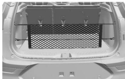
Este vehículo puede contar con una red de conveniencia en la parte trasera del vehículo. Fijela a los amarres para carga para guardar cargas pequeñas.
