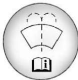
Abra el tapón que tiene el símbolo del lavaparabrisas. Agregue líquido para lavaparabrisas hasta llenar el tanque. Vea en *Vista general del compartimento del motor* ⇨ 211 la ubicación del depósito.
