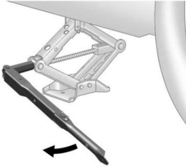
4. Coloque el extremo de tubo hexagonal de la llave sobre la cabeza hexagonal del gato para unirlos.
