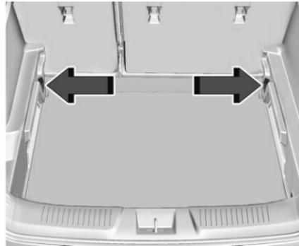
3. Sujete el piso de carga por los lados y jale ligeramente hacia atrás, después deslice el piso de carga en las ranuras de retención. El piso de carga permanecerá en la posición abierta.
