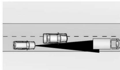
El ACC no detectará un vehículo adelante hasta que esté completamente en el carril y es posible que no aplique los frenos automáticamente si es necesario. Siempre debe estar preparado para aplicar manualmente los frenos en situaciones de emergencia.
